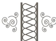
Intrínsecamente impermeable al aire, BOOST'R HYBRID actúa como barrera frente a las infiltraciones de aire proveniente del exterior y a las pérdidas de calor por convección originadas desde el interior.
